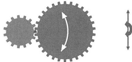
図 16 曲げねじり連成振動のイメージ
